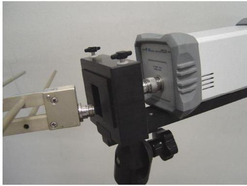
Рисунок 11-16 Присоединение логопериодической антенны к PMM
