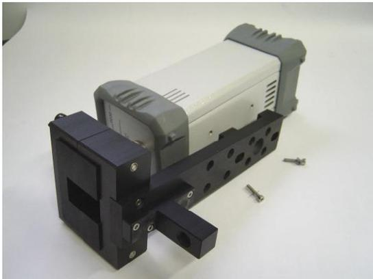
**Рисунок 11-13 Монтаж держателя антенн на PMM 9030/9060/9180**
