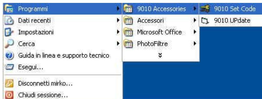
Щёлкните на опции **9010 Set Code** (Установка кода прибора 9010) (файле **WRDONGLE.EXE**) один раз для открытия окна установки кода, затем скопируйте и вставьте **40 разрядный код активации** в поле **Dongle Code** (Код аппаратного ключа) и нажмите кнопку вниз,
