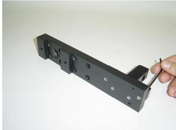
Рисунок 11-7 Монтирование шарнира штатива
