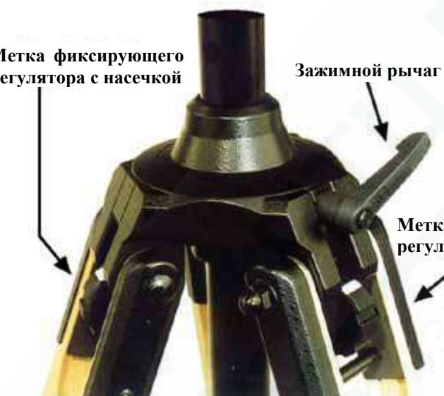
**Рис. 1-19** Регулируемый стык
