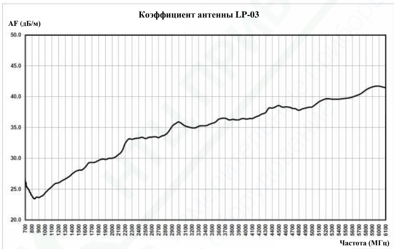
**Рис. 1-11 Стандартный коэффициент логопериодической антенны LP03**
