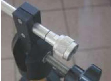
Измените поляризацию антенны с горизонтальной на вертикальную или наоборот, а затем полностью затяните ручку.
