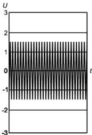
а) Немодулированный радиочастотный сигнал (пиковое значение напряжения
