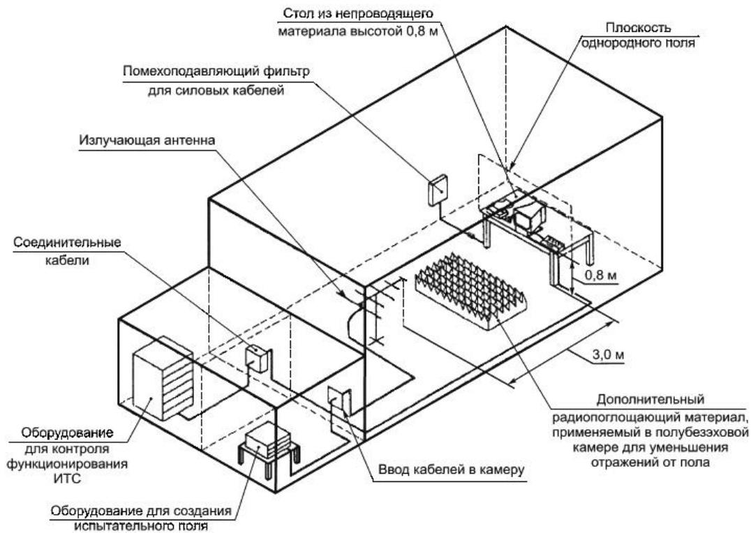
Рисунок 2 - Пример испытательной установки
