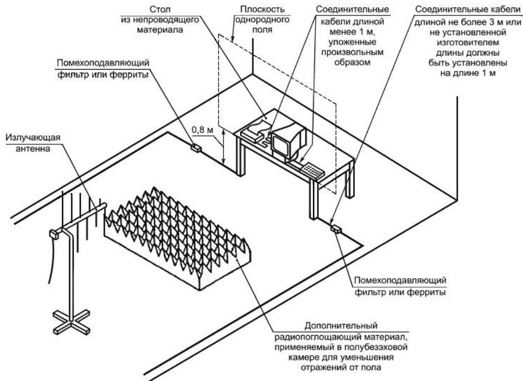
Рисунок 6 - Пример установки для испытаний настольных ТС
