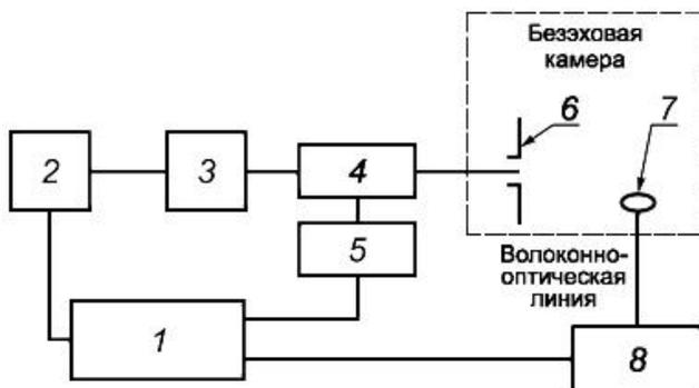
1 - контроллер, например персональный компьютер; 2 - генератор сигналов; 3 - усилитель мощности; 4 - направленный ответвитель; 5 - измерительный прибор; 6 - передающая антенна; 7 - антенна (датчик) для измерения напряженности поля; 8 - измеритель напряженности поля
