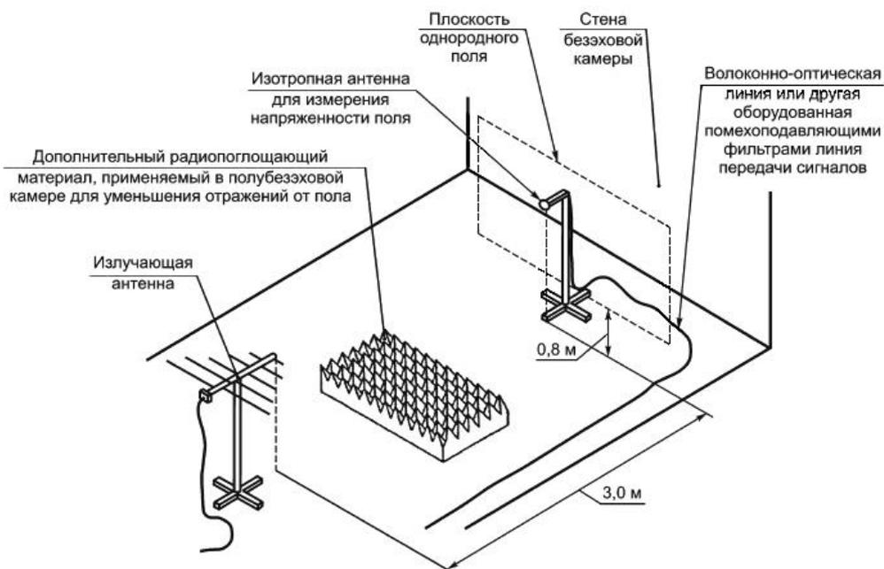
Рисунок 3 - Расположение оборудования при калибровке испытательного поля
