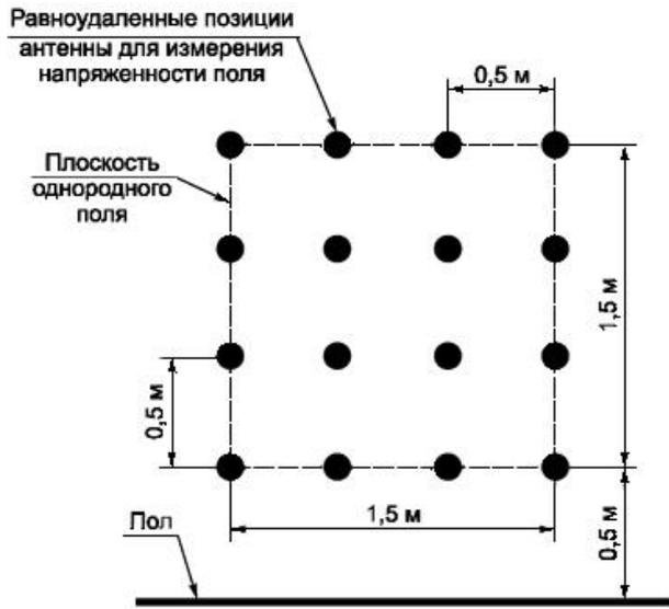
Рисунок 4 - Пример плоскости однородного поля размерами 1,5×1,5 м
