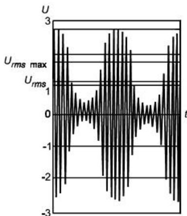
b) Модулированный радиочастотный сигнал при глубине модуляции 80% ( $U_p = 2,54$  В,  $U_{rms} = 1,12$  В, максимальное среднеквадратичное значение напряжения  $U_{rms\ max} = 1,8$  В)
