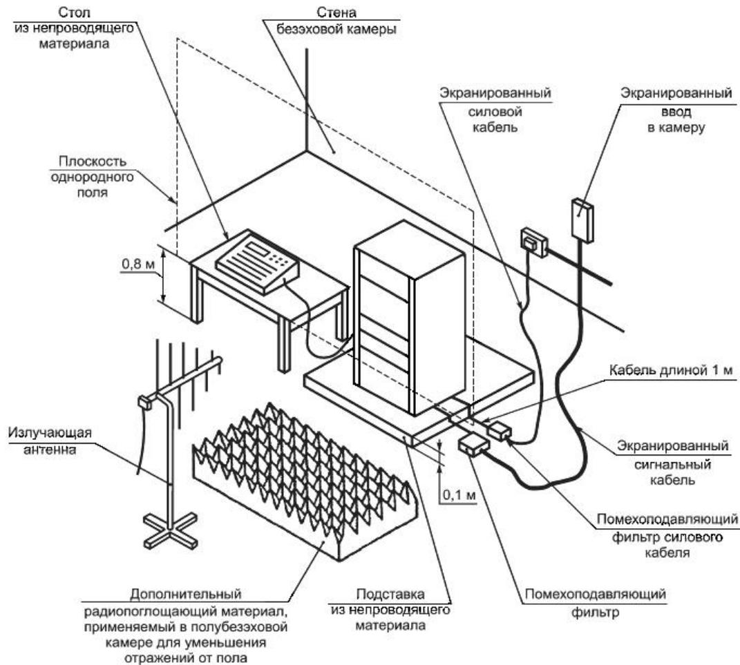
Рисунок 5 - Пример установки для испытаний напольных ТС
