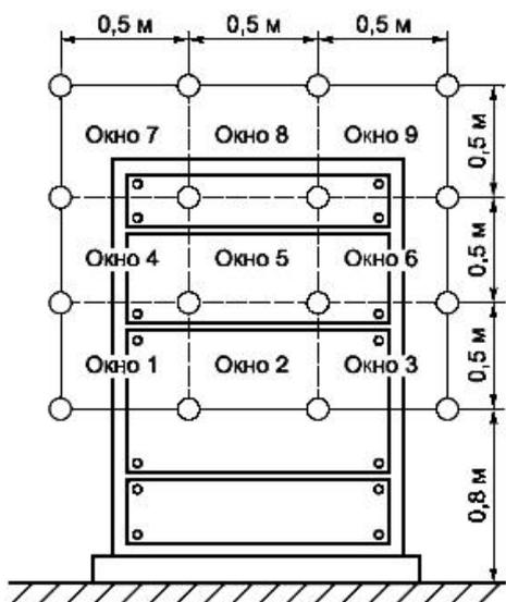
б) Напольное ТС (при калибровке поля и испытаниях используются окна 1-9)
