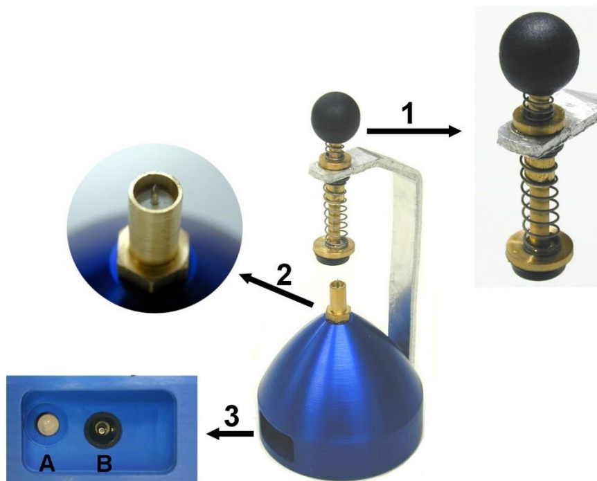
Рис. 4-3 Элементы EP600 CHARGER
