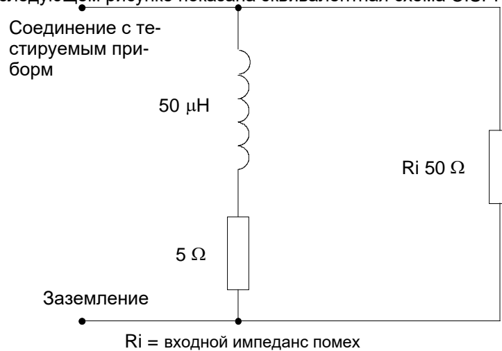
Эквивалентная схема CISPR
