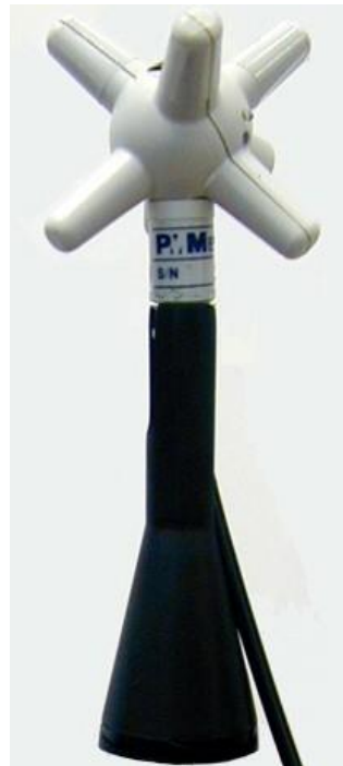
Рис. 2-3 EP60x установленный в коническую подставку
