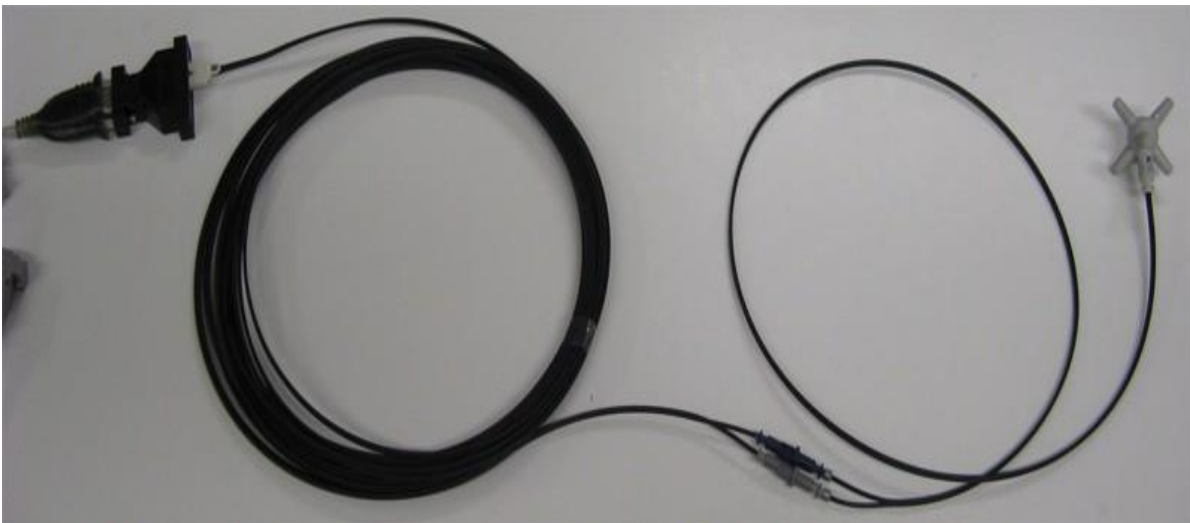
Рис. 2-2 Подключение EP60x с удлинителем FO-EP600/10 по USB
