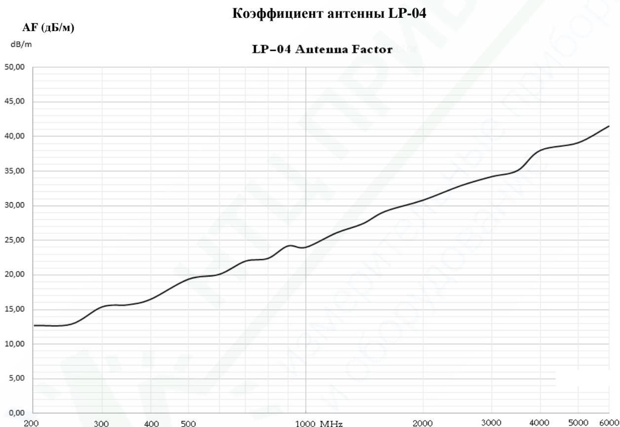
**Рис. 1-14** Стандартный коэффициент логопериодической антенны LP04
