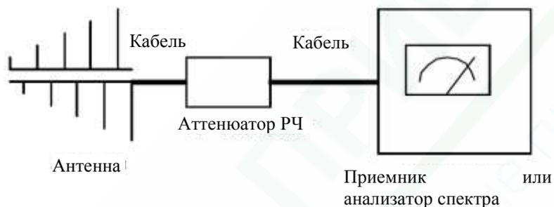
Рис. 3-3 Установка для испытания на воздействие внешних факторов
