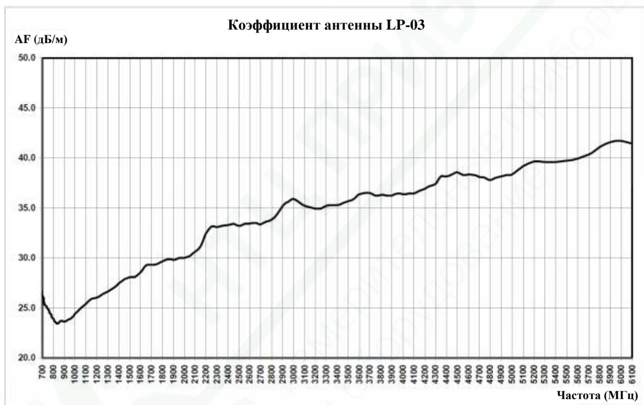
Рис. 1-11 Стандартный коэффициент логопериодической антенны LP03
